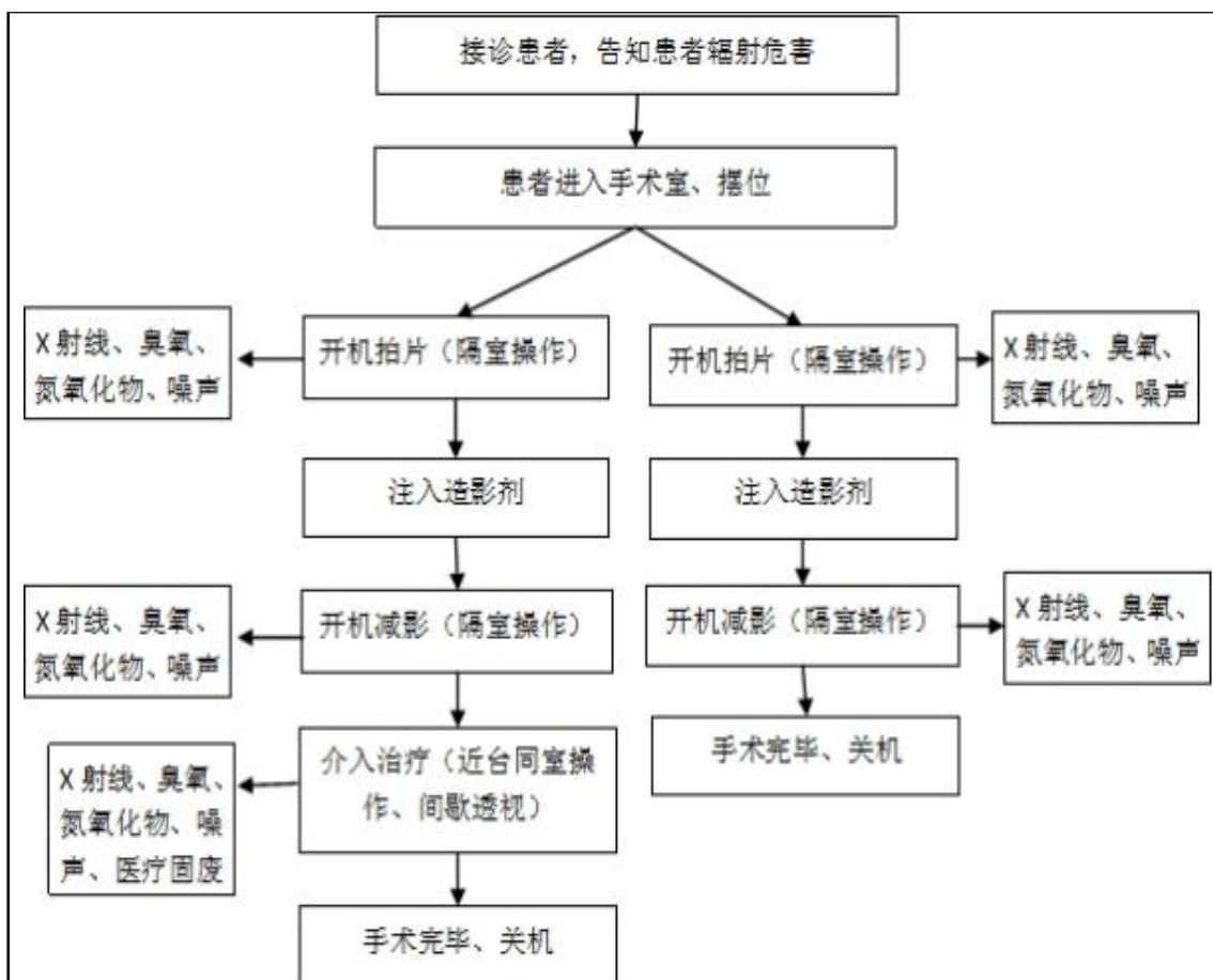
图 2-1 中型 C 臂治疗流程及产污环节示意图
